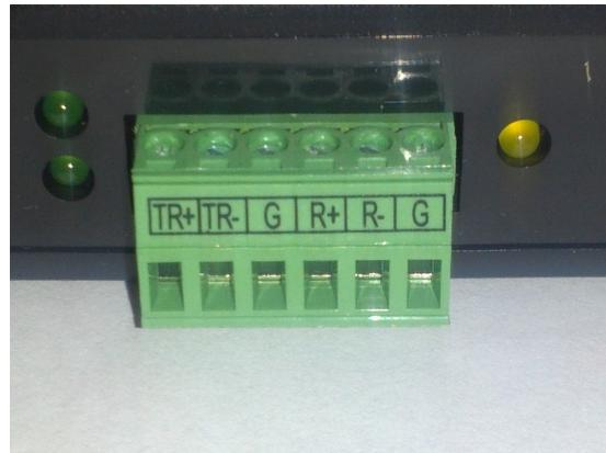
**Blå**      -> **TR+** (*RJ45 pin 3 forbindes til converter TR+*)
